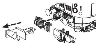
Verwendung der beiliegenden Steckteile.
